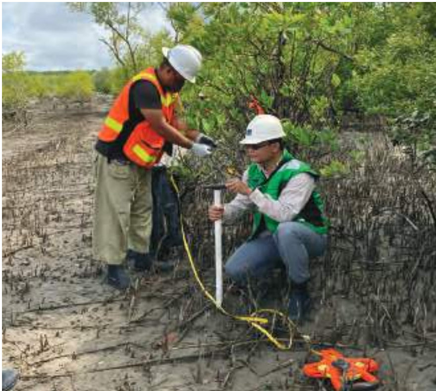
Pengukuran laju sedimentasi dengan sedimentation stake
